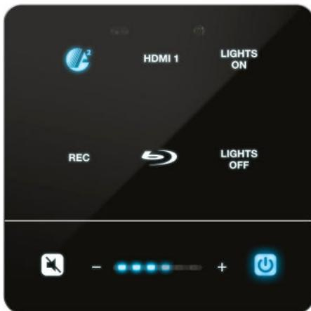
*Allumage et extinction synchronisé à l'aide d'un panneau de commande mural (permet d'éviter certaines erreurs pouvant résulter de l'utilisation de plusieurs télécommandes)*
